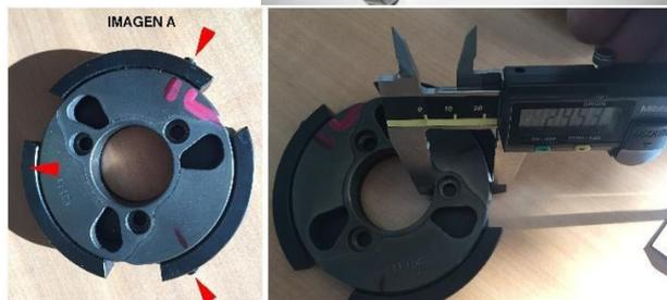
maquinado) e todas as “sapatas” devem estar completamente fechadas, sem qualquer abertura.
