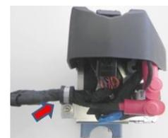
**6.6.7.4.** Nos motores 125 Micro MAX Evo, 125 Mini MAX Evo e 125 Junior MAX Evo, pode utilizar-se uma peça para tapar a ficha de ligação da válvula eletrônica, que tem como referência Rotax 666900.
