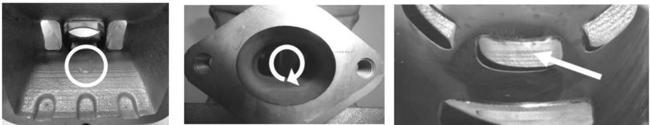
**6.3.11.** As dimensões horizontais e verticais da saída de escape (no cilindro Junior 223994, com a saída de escape totalmente mecanizada com CNC) deve-se verificar com a peça ROTAX referência 676240.
