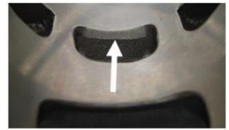
**6.3.8.** Nos cilindros 223 993, 223 994 e 613 933 é permitida a maquinação CNC (de fábrica) na parte superior do transfer central ("boost").
