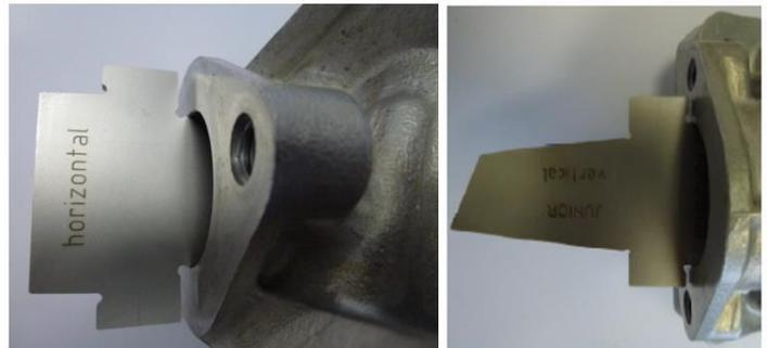
A peça deve mover-se na posição quer horizontal quer vertical, dentro da saída de escape. Em qualquer das direções a peça não pode tocar na parede da saída de escape, conforme imagem.
