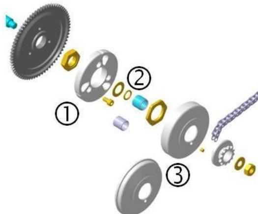
**6.7.2.** Embraiagem de metal original Rotax. Só pode ser utilizada a «sapata» com a referência 659907.
