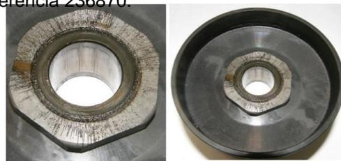
As imagens mostram a situação extrema de existência de substância lubrificante na campânula, mesmo que a massa lubrificante passe a área do rolamento com o «o-ring» instalado.
