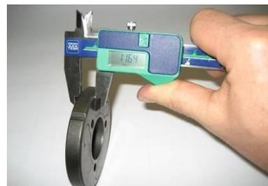
**6.7.7.2.** Altura da sapata da embraiagem (conforme imagem). A medida não pode ser inferior a 24,10 mm.
