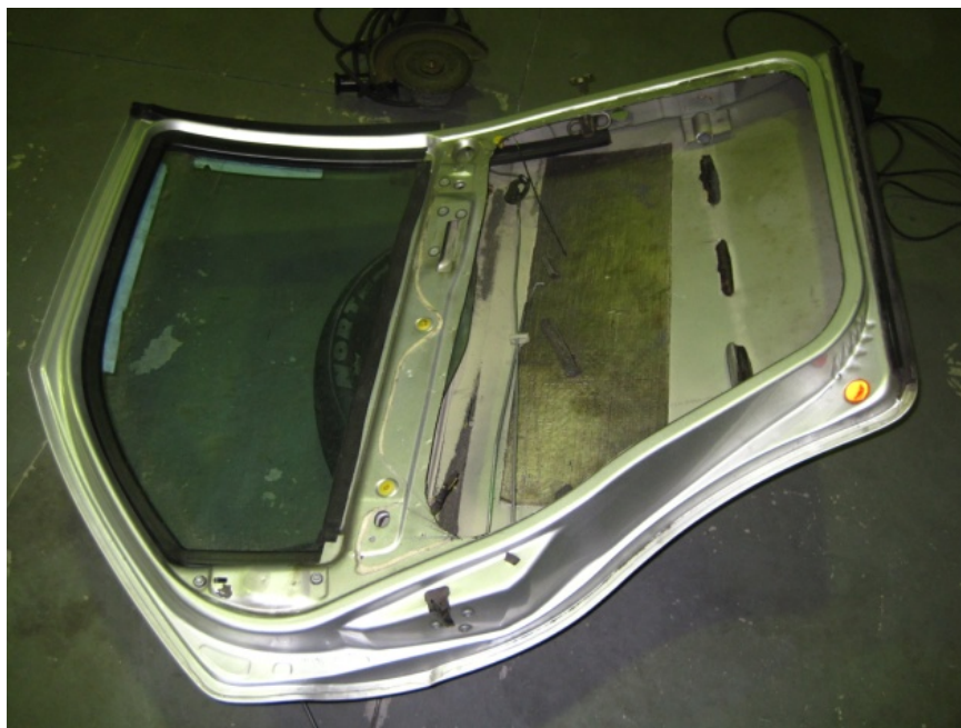
Figura 3 – Porta traseira após remoção do interior e chapa interior.
