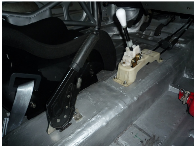
Figura 2 – Posicionamento do comando da caixa de velocidades e travão de mão.
