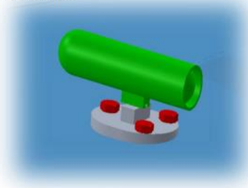
VISTA COM ZOOM: DETALHE DA CÂMARA TIPO CILINDRICO SOBRE UMA SUPERFÍCIE, FIXADA COM PARAFUSOS, PORCASE ANILHAS
