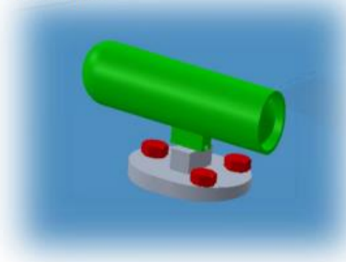
VISTA COM ZOOM: DETALHE DA CÂMARA TIPO CILÍNDRICO SOBRE UMA SUPERFÍCIE, FIXADA COM PARAFUSOS, PORCASE ANILHAS
