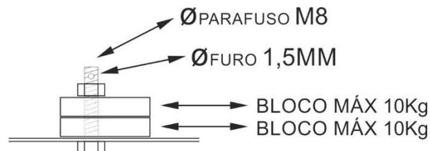
Figura 3 - Exemplo de fixação de lastro
